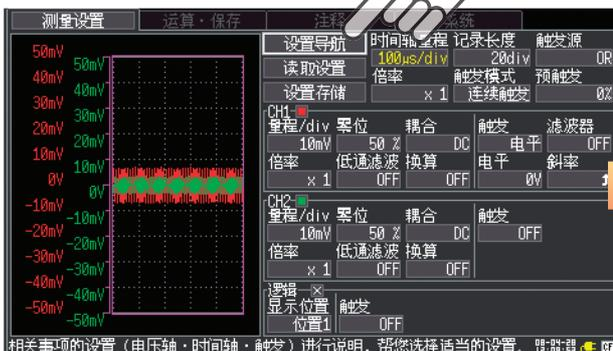
导入电源后的最初画面为波形监控的设定画面。然后请点击“设置导航”进行新设置。
