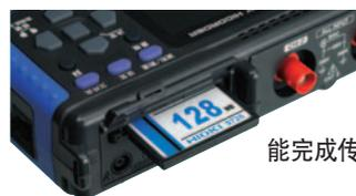
可以在 CF 卡上进行数据存储，用 USB2.0 与电脑连接，可以读取数据。20,000div 的波形图，20 秒就能完成传送，进行观测。
